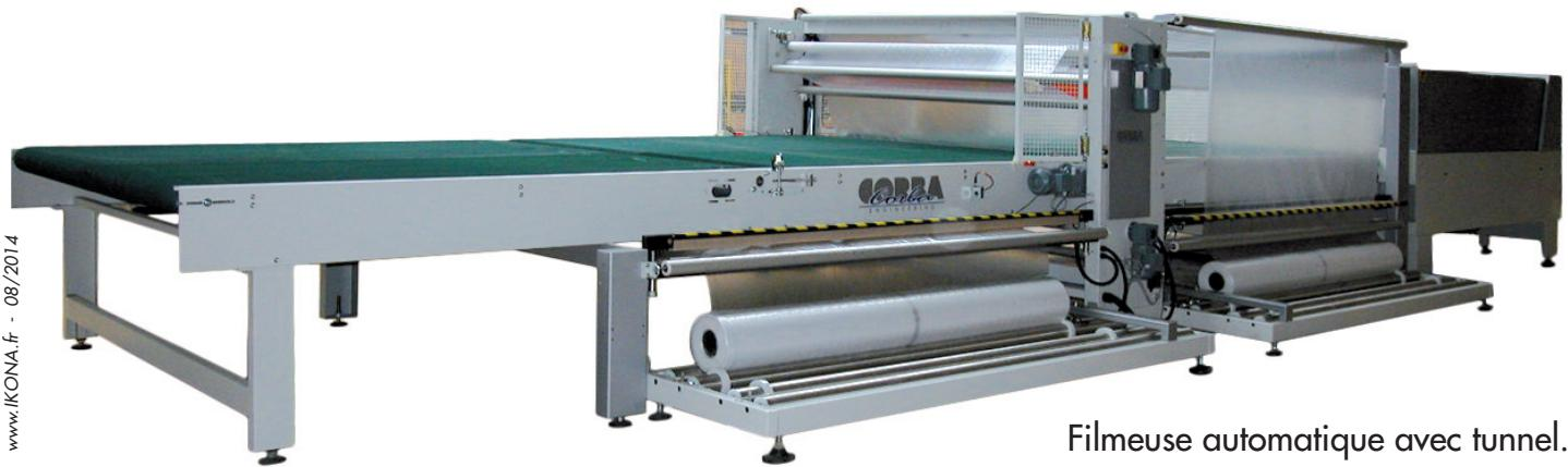
Filmeuse automatique avec tunnel.
